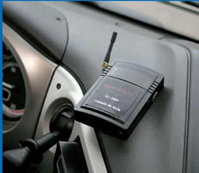
El sistema GC-3000 combina la tecnología GSM (móvil) con la de radiofrecuencia, lo que ayuda a proteger las pertenencias en cualquier vehículo.
